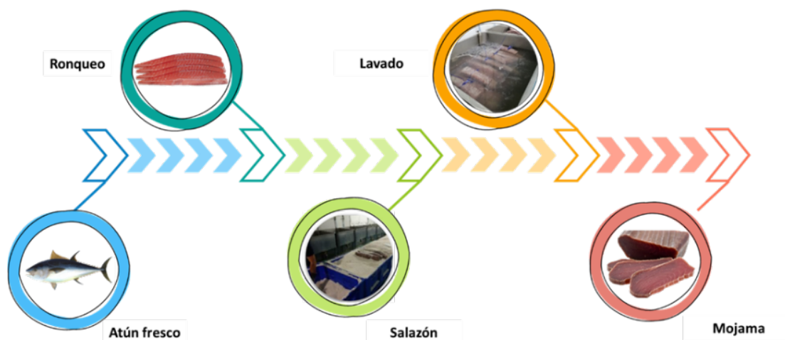
Figura 1. Diagrama de flujo del proceso de elaboración de mojama
