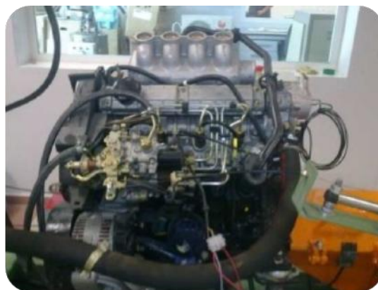
Figura 3. Motor diésel con el que se realiza el ensayo
