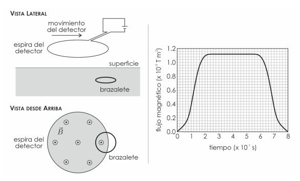
La figura de la derecha representa el flujo magnético  $\Phi$  a través del brazalete cuando el detector se mueve a velocidad constante y paralelo a la superficie.
