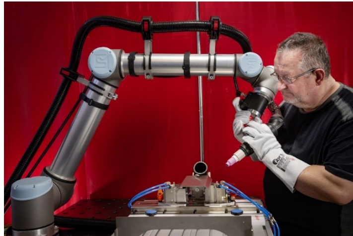
Ilustración 3. Cobot con trabajador para realizar soldadura
